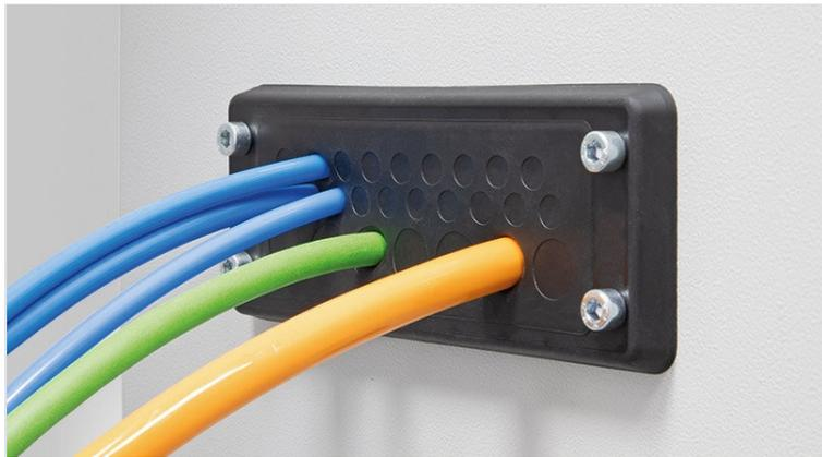
La membrane passe-câbles KEL-DPR 24 est basée sur une membrane déjà éprouvée, la KEL-DP 24. Elle possède en plus un cadre intégré en polypropylène. Avec le KEL-DPR 24, jusqu'à 48 câbles de 1 à 16,1 mm de diamètre peuvent être insérés et scellés conformément à l'IP65.
