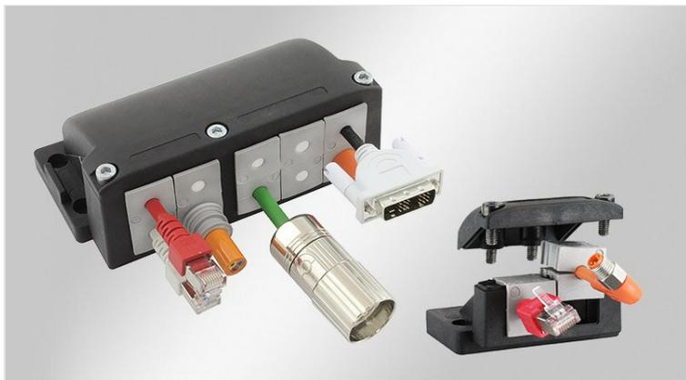
L'introduction dans les boîtiers à brides KEL-FG avec une étanchéité et une tenue à la traction selon la norme EN 62444 pour les câbles pré-confectionnés et les gaines à un angle de 90 ° restent une proposition unique sur le marché. Le boîtier à bride KEL-FG avec des douilles filetéés intégrées est facile à installer.
