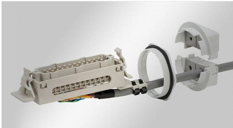
Die teilbare Kabelverschraubung KVT-SNAP ermöglicht die Einführung von Leitungen mit Steckern oder fertigen Kabelsätzen. Aber auch nicht konfektionierte elektrische, pneumatische oder hydraulische Leitungen sowie Wellschläuche lassen sich mit der teilbaren Kabelverschraubung KVT-SNAP problemlos in Schaltschränke, Gehäuse oder Maschinen einführen und abdichten.
